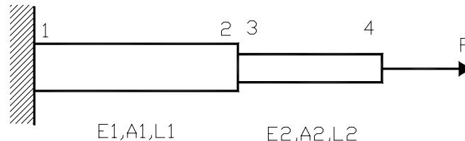
$$k = \begin{pmatrix} k_1 + k_2 & -k_2 \\ -k_2 & k_2 \end{pmatrix}, \quad k^{-1} = \begin{pmatrix} \frac{1}{k_1} & \frac{1}{k_1} \\ \frac{1}{k_1} & \frac{k_1 + k_2}{k_1 k_2} \end{pmatrix}, \quad p = \begin{pmatrix} 0 \\ 1 \end{pmatrix}$$
